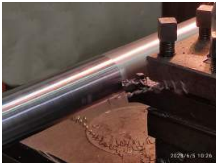
Рис. 3. Чистовое точение экспериментальной режущей пластиной
