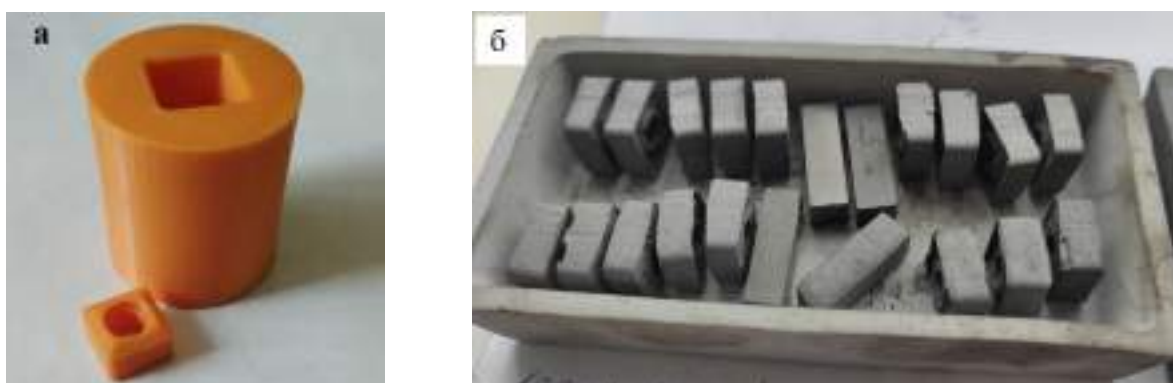
Рис. 1. Пластиковая пресс-форма (а), спрессованные заготовки режущих пластин из T5K10 (б)
