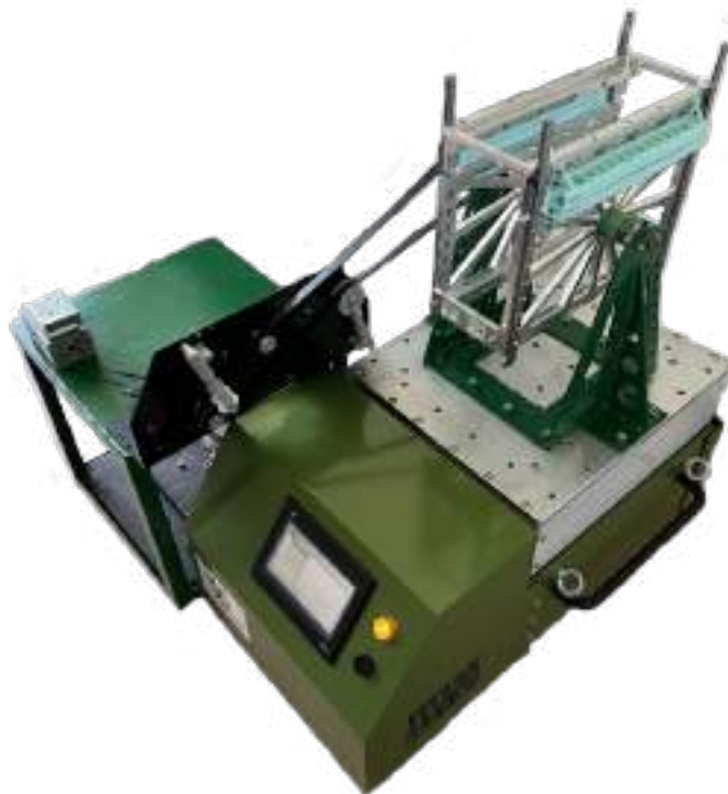
Рис. 3. Фотография экспериментального образца ИТПК для наноспутников стандарта CubeSat 1U-6U, установленного на поворотное основание
