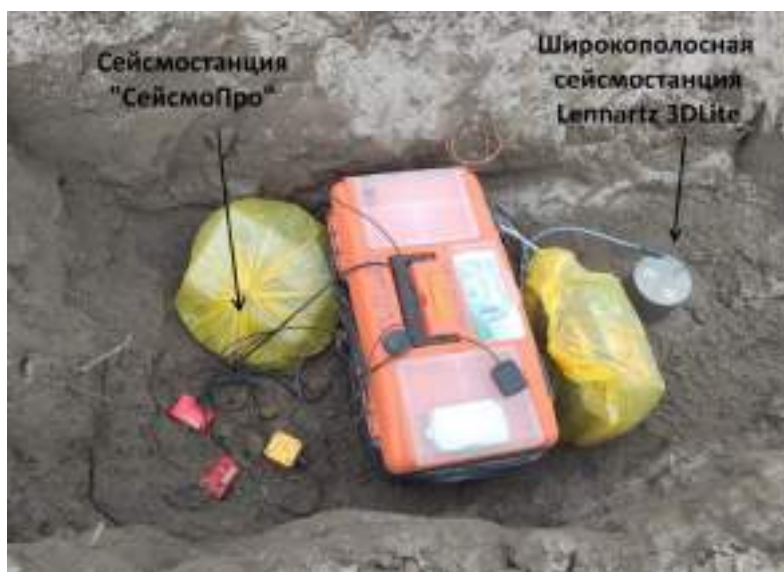
Рис. 3. Временный пункт наблюдений за извержением вулкана Шивелуч. Сейсмостанции расположены на дне ямы глубиной около 1 м на подготовленном каменном фундаменте
