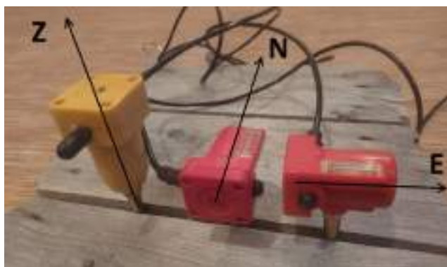
Рис. 2. Геофоны с собственной частотой 4,5 Гц, установленные по сторонам света (три компонента)
