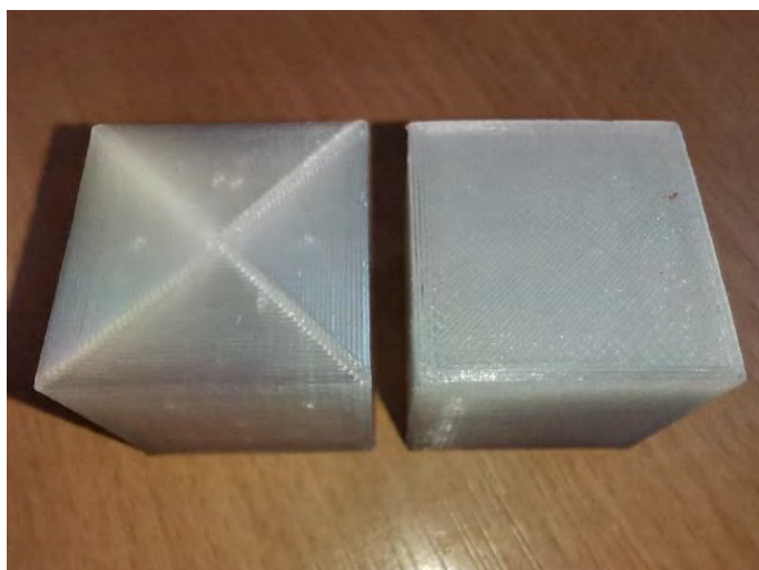
Рис. 2. Образцы термополимеров (слева – концентрическое заполнение образца, справа – перекрестное заполнение)
