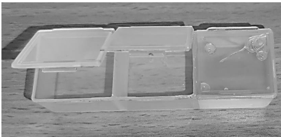
Рис. 1. Форма для проведения акустических измерений
