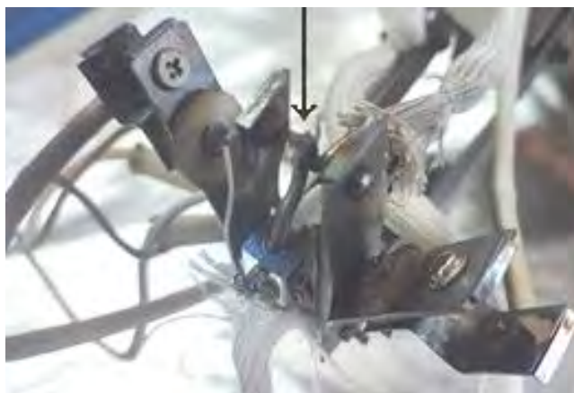
Рис. 1. Термопара К-типа, установленная на центральный держатель образца
