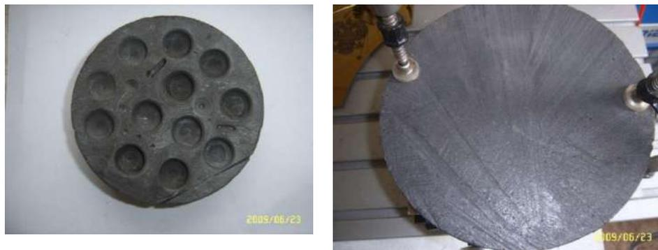
**Рис. 1.** Внешний вид многоячейстой подложки и площадки из электротехнического графита
