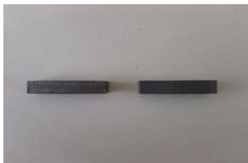
**Рис. 4.** Твердосплавные образцы, полученные в пресс-форме, изготовленной методом 3D печати
