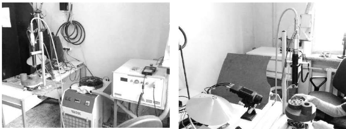
**Рис. 2.** Процесс изменения режима лазерной агломерации золота на опытном образце лабораторной установки на основе иттербиевого волоконного лазера
