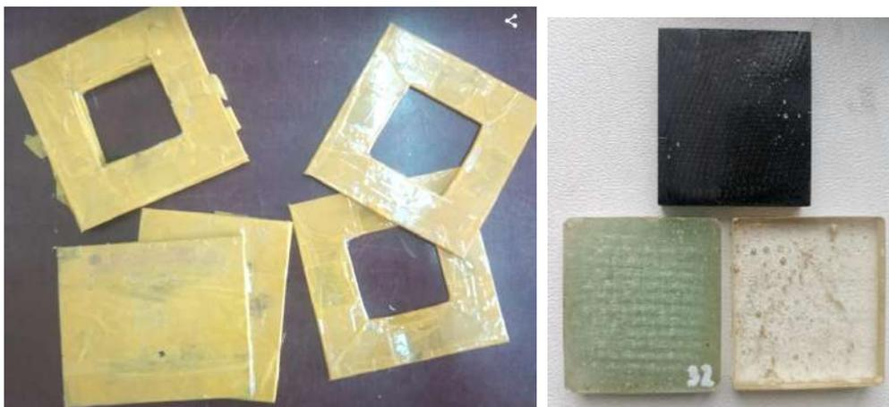
**Рис. 2.** Форма для отливки образцов из эпоксидной смолы ХТ-116 (а) и соответствующие образцы, полученные с использование данных форм (б)
