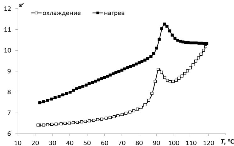
**Рис. 4.** Температурная зависимость  $\epsilon'(T)$  для композитного образца на основе SBA-15 с внедренным в поры  $\text{NH}_4\text{IO}_3$  на частоте 1 кГц
