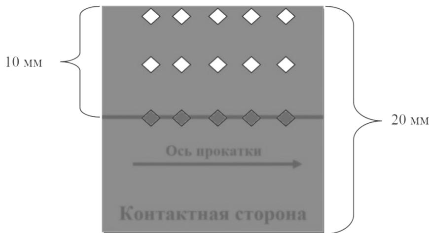
**Рис. 1.** Принципиальная схема измерения микротвердости,
